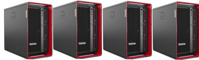
Cluster and Grid Sandbox (LLM & SML – 4 nodos) Procesamiento 96 cores en cpu's, Memoria Ram 2 TB, Almacenamiento 48 TB, GPU's 1,152 núcleos Tensor (4 NVIDIA RTX 6000 ADA - 48 Gb).
